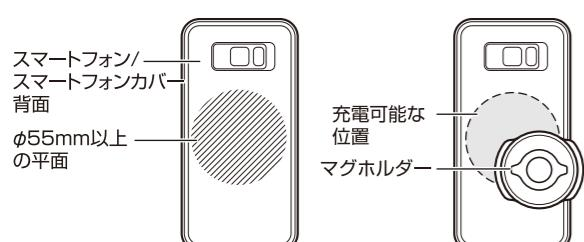
②①で確認した位置が金属リング取付位置です。取り付ける際にはスマートフォン/スマートフォンカバー側にマスキングテープ等で上下左右に目印を付けるとやりやすくなります。
